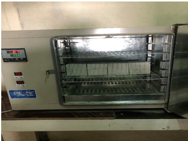
Рис. 4. Процесс сушки газобетонных кубов в сушильном шкафу в течение 24 часов
