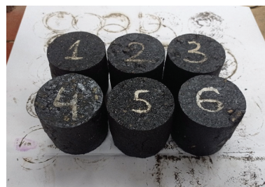
Рисунок 1. – Стандартные цилиндрические образцы размерами 71,4 мм
