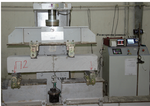
Рис. 6. Установка для испытания перемычек
