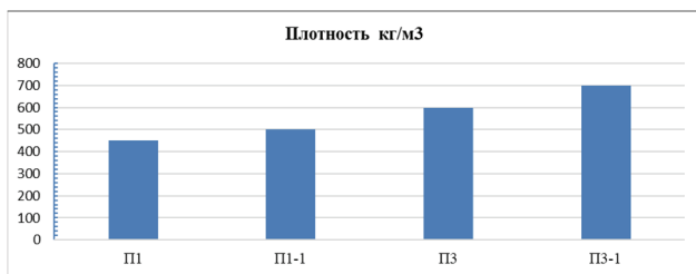
Рис. 15. Влияние микрокремнезема на сухую плотность автоклавных газобетонных блоков группы Б
