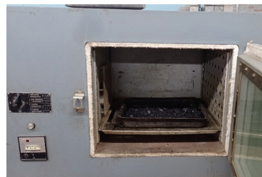
Рисунок 2. – Смеси, размещенные в сушильном шкафу
