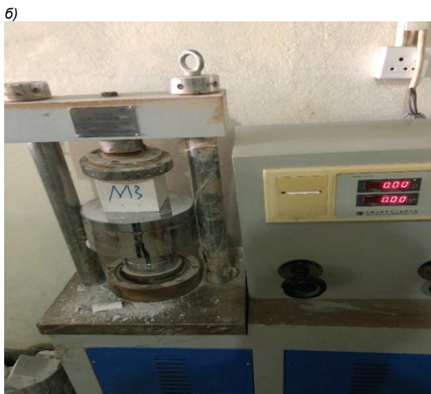
Рис. 3 Испытание вспомогательных образцов а) испытание на сжатие кубического образца газобетона; б) образцы перед испытанием.
