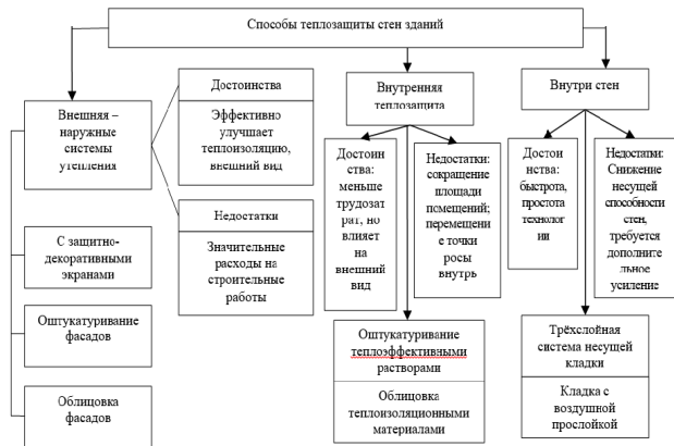
Рисунок 3 – Классификация способов теплозащиты стен зданий
