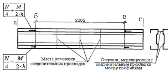
Рисунок 2 - Схема модели исследуемой части верхнего пояса фермы
