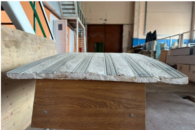
Рис. 3. Модель ЛБП с заполнением внутреннего пространства между поясами твердеющим составом
