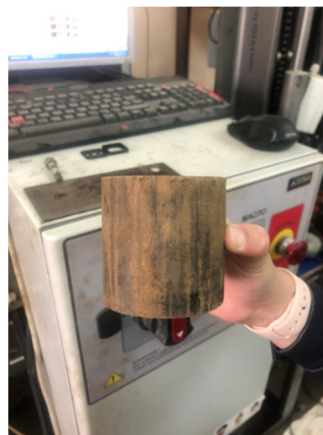
Рисунок 2 – Фотография образца после испытания на прочность при сжатии с вертикальным расколом
