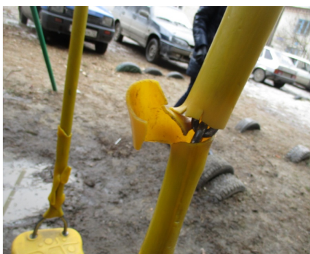
Рис. 6 – Дефекты пластмассовых элементов на МАФх
