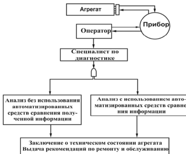
Рис. 2. Схема определения технического состояния системы неавтоматизированным методом
