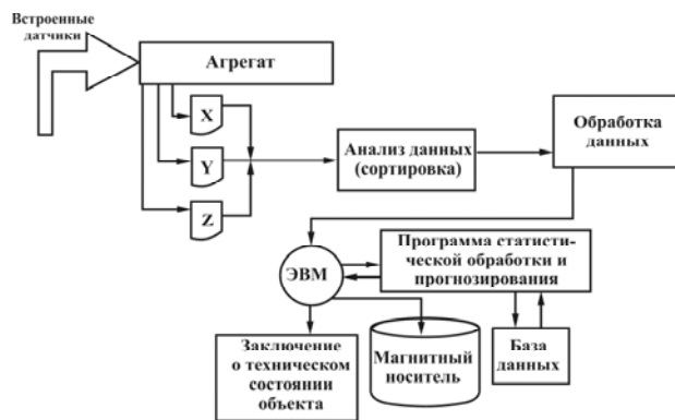
Рис. 3. Принципиальная упрощенная блок-схема мониторинга силовой установки
