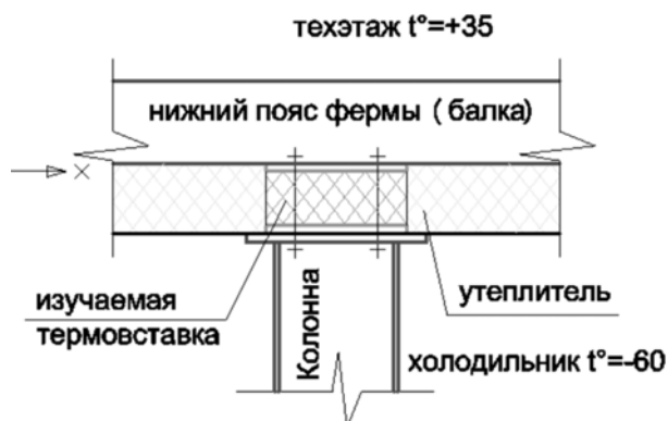
Рис. 4. Узел сопряжения стропильной конструкции с колонной с применением термовкладыша.
