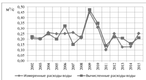
Рис. 2. Совмещенный график значений измеренных и вычисленных максимальных расходов воды р. Воробьевка (м³/с) за время наблюдений
