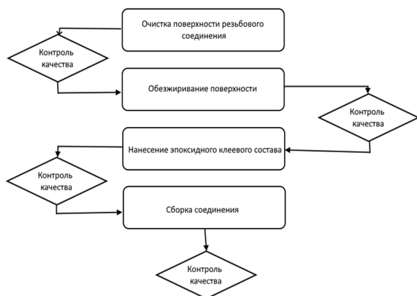
Рис. 1 – Технологический алгоритм сборки муфты
