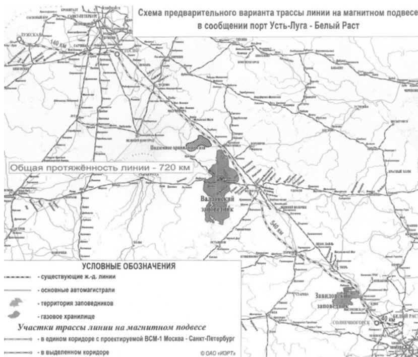
Рис. 4. Схема предварительного варианта трассы от портов Санкт-Петербурга до терминалов Москвы
