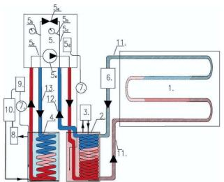
1. — Модельная плита; 2. — Теплообменник нагревательного контура; 3,8 — Миксеры 4. — Теплообменник теплосъемного контура; 5. — Компрессорный блок; 6. — Циркуляционный насос; 7. — Терморегулятор; 9. — Силовой контактор; 10. — Проточный водонагреватель; 11. — Нагревательный контур модельной плиты; 12. — Теплоподающий контур компрессора (конденсатор); 13. — Теплоотбирающий контур компрессора (испаритель).
