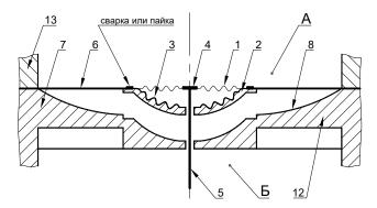
Рисунок 1. Составной мембранный чувствительный элемент
