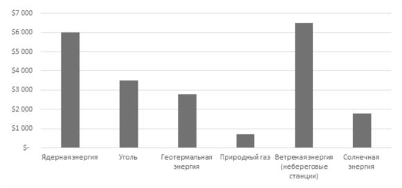
Рисунок 2 — Сумма капитальных затрат на строительство электростанции на 1 КВт энергии без начисления ссудных процентов и дисконтирования, доллар США за 1 КВт Источник: Составлено автором на основе U.S. energyinformationadministration - CostandPerformanceCharacteristicsofNewGeneratingTechnologies, AnnualEnergyOutlook 2021
