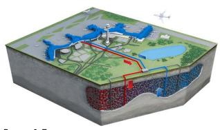
Рисунок 9. Принципиальная схема реверсивного использования низкотемпературной геотермальной энергии в летний период
