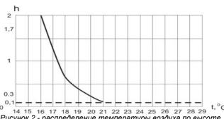
14 15 16 17 18 19 20 21 22 23 24 25 26 27 28 29 Рисунок 2 - распределение температуры воздуха по высоте (дана в метрах) рабочей зоны производственного цеха, оборудованного газовыми инфракрасными излучателями
