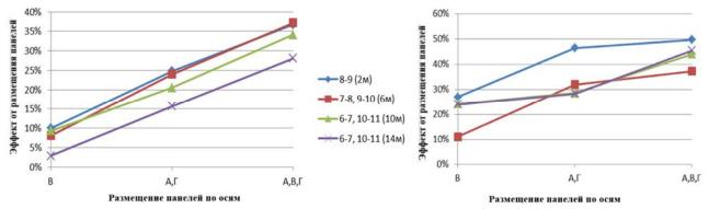
Рис. 3 Графики эффективности устройства связевых панелей, зависящие от их количества в поперечном сечении здания: а - для регулярной схемы колонн в плане здания; б - для нерегулярной схемы
