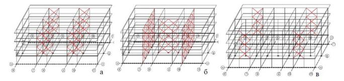
Рис. 1 Расположение связевых панелей: а - по осям A, B и Г в нерегулярной схеме; б - в продольном и поперечном направлениях в нерегулярной схеме; в - по осям A и Г в регулярной схеме
