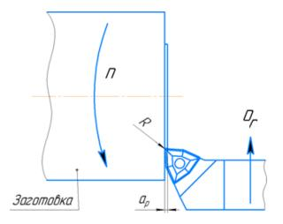
Рис. 1. Процесс торцевания
