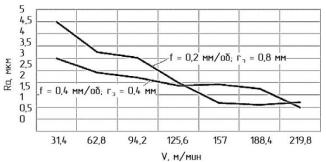
Рис. 2. Влияние скорости точения на значение среднего параметра шероховатости
