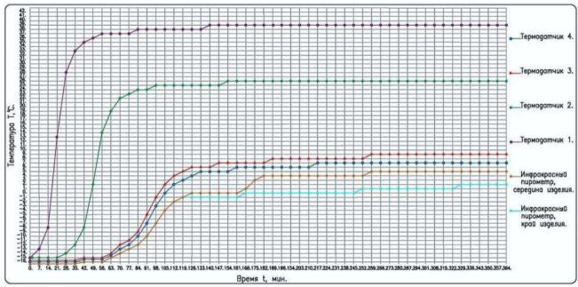
Рисунок 13. График процесса изменения температуры на поверхностях и в слоях во времени на экспериментальной модели одежды ездового полотна
