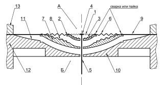
Рисунок 2. Составной мембранный элемент из трех мембран
