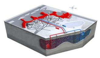
Рисунок 7. Принципиальная схема использования низкотемпературной геотермальной энергии в зимний период
