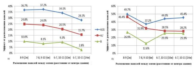
Рис. 2 Графики эффективности устройства связевых панелей в продольном направлении по одной, двум и трем осям: а -для регулярной схемы колонн в плане здания; б - для нерегулярной схемы колонн в плане здания
