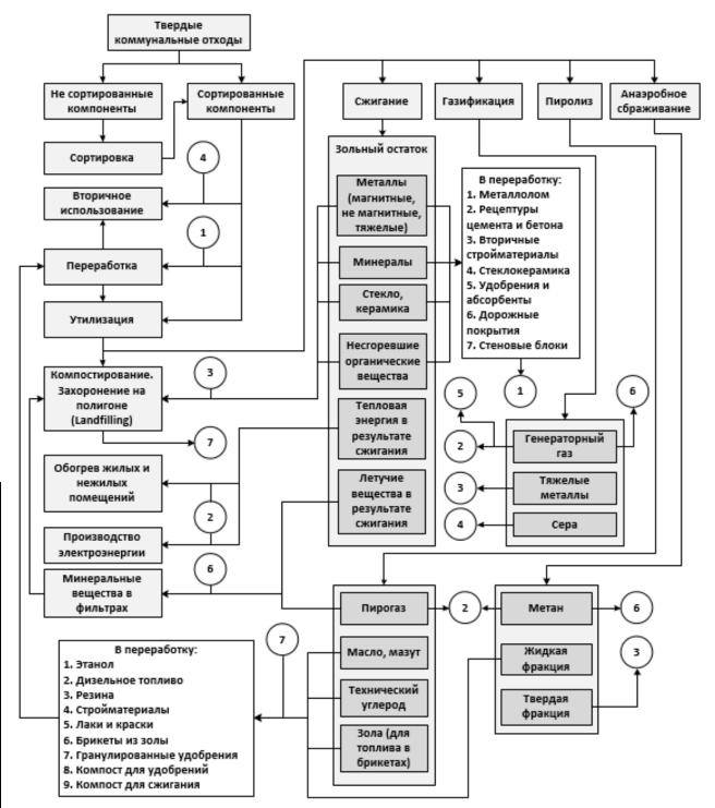
Рисунок 1 - Схема управления твердыми коммунальными отходами, а также результатами их переработки
