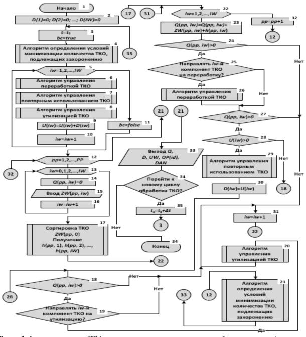
Рисунок 2 - Алгоритм управления ТКО (сортировка, повторное использование, переработка и утилизация)
