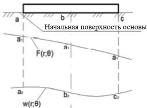
Рис. 1 Перемещение точек плиты
